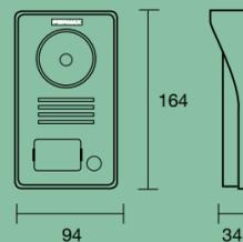
Botoneira de rua de vídeo WAY-FI. Montagem de superfície. Fabricada em alumínio. IP 44 IK 07. Porta-cartões com retroiluminação. Viseira de proteção incluída, necessária na instalação. Câmara CMOS a cores de grande ângulo (120°H 72°V). Sensor de iluminação. Temperatura de funcionamento: -15°C a 55°C. Dim.: 94(H) x 164(V) x 34(P)mm (com viseira). Relé integrado para abertura de uma 2ª porta. Consumo máx. trínco: 250mA.
