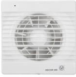
Ventiladores helicoidais extra-finos, com comporta anti-retorno incorporada, luz piloto de funcionamento, motor 127V-60Hz e 220V-60Hz, com protetor térmico, para trabalhar a temperaturas até 40°C. Dois tamanhos diferentes para dutos de 100 e 120 mm. Vazões aproximadas de 100 e 200 m<sup>3</sup>/h, respectivamente, em descarga livre. Para cada tamanho realizam-se diferentes construções para escolher o modelo mais adequado a cada instalação.
