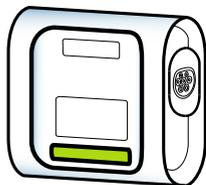
La luz de baliza LED en el punto de recarga informa sobre diferentes mensajes de estado o error, usando diferentes colores y secuencias.
