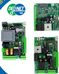
Uma **só central** para todos os nossos motores, nas versões 230V e 24V.
