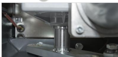
Moto-reductor com **parafuso sem fim e engrenagens de aço, coroa de bronze**, lubrificada por massa de **baixa viscosidade**, garantindo uma longa duração e uma reduzida taxa de desgaste.
