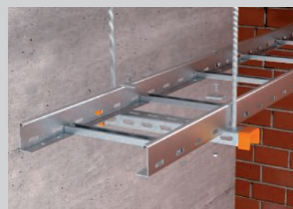
Montagem do perfil transversal com fixador, parafusos de cabeça boleada e anilha larga.
