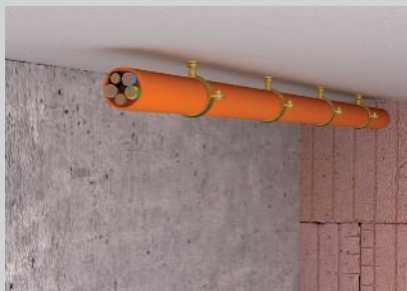
Instalação sob o teto.
