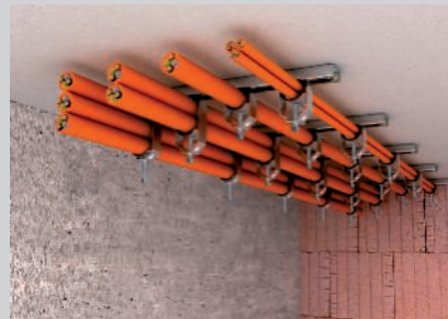
Instalação horizontal de cabos com abraçadeiras BBS no teto.
