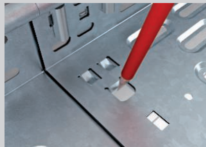
União sem parafusos, apenas as patilhas de fixação necessitam ser dobradas.
